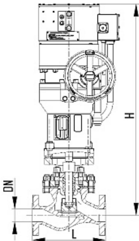
Наименование оборудования: [Клапаны запорные проходные с электроприводом сальниковые, фланцевые, DN50мм, PN1,0МПа](#)
