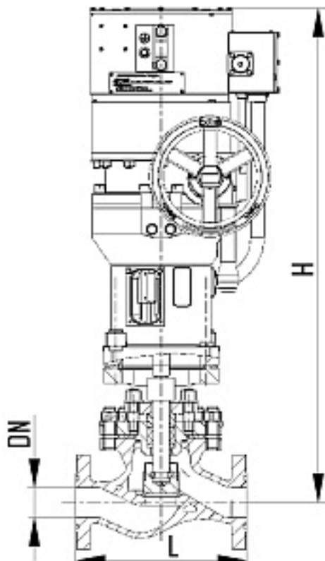
Наименование оборудования: [Клапаны запорные проходные с электроприводом сальниковые, фланцевые, DN100мм, 1,0МПа](#)
