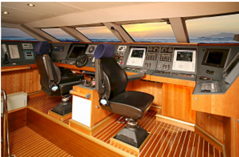
Наименование оборудования: Интегрированная мостиковая система Производитель: АКЦИОНЕРНОЕ ОБЩЕСТВО "МОРСКИЕ НАВИГАЦИОННЫЕ СИСТЕМЫ"
