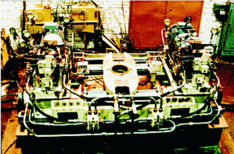
Наименование оборудования: [Электрогидравлическая рулевая машина плунжерного типа P18M1-2](#)
