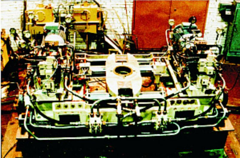
Наименование оборудования: [Электрогидравлическая рулевая машина плунжерного типа P21M3](#)
