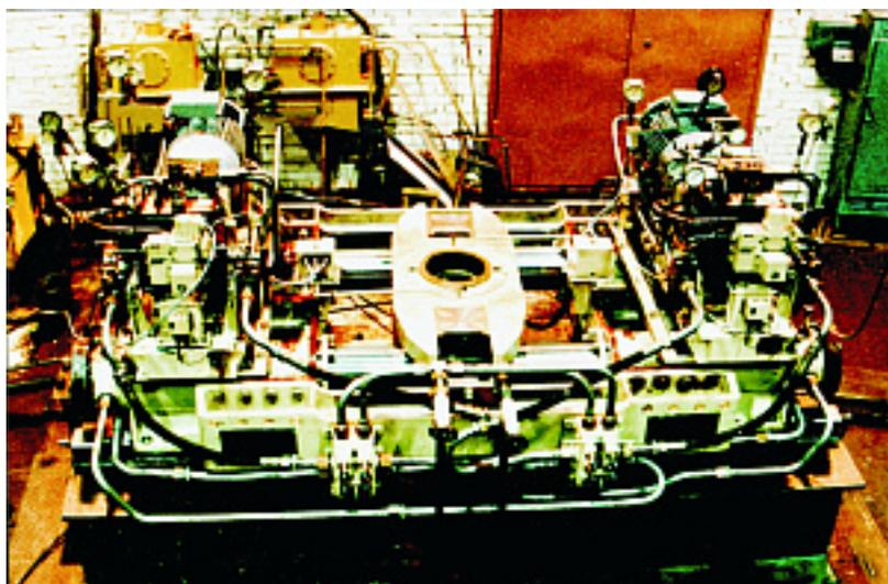
Наименование оборудования: [Электрогидравлическая рулевая машина плунжерного типа Р24М1-1](#)
