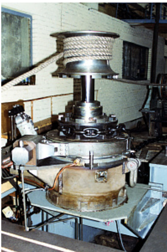
Наименование оборудования: Шпиль якорно-швартовный гидравлический ШГ-25 Производитель: ЗАКРЫТОЕ АКЦИОНЕРНОЕ ОБЩЕСТВО "ЦЕНТРАЛЬНЫЙ НАУЧНО-ИССЛЕДОВАТЕЛЬСКИЙ ИНСТИТУТ СУДОВОГО МАШИНОСТРОЕНИЯ"
