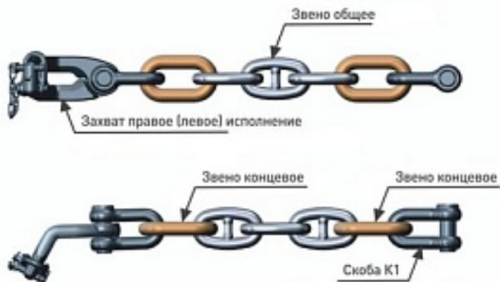
Наименование оборудования: [Стопор цепной тип 1 для крепления якорного каната при стоянке на якоре](#)
