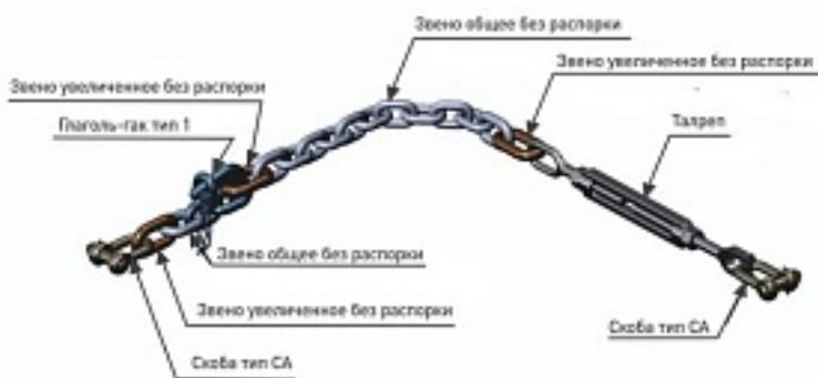
Наименование оборудования: [Стопор цепной для крепления якоря "по-походном" в штормовых условиях](#)
