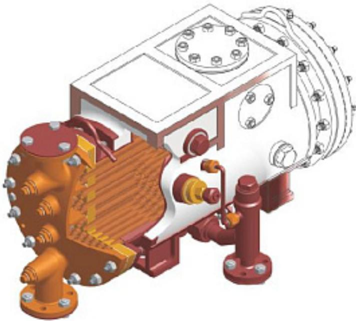
Наименование оборудования: [Конденсаторы отработавшего пара типа ХВ](#)
