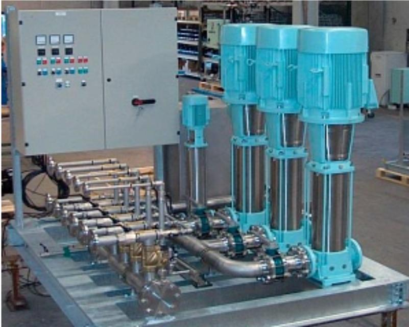
Наименование оборудования: [Система пожаротушения тонкораспыленной водой](#)
