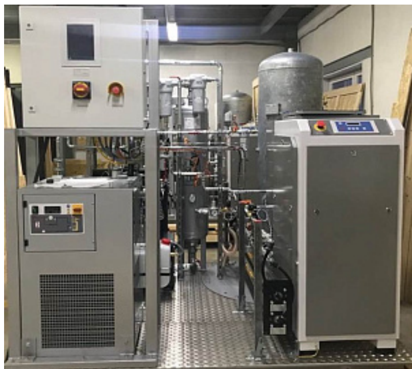
Наименование оборудования: Генератор азота СГА-44 Производитель: ОБЩЕСТВО С ОГРАНИЧЕННОЙ ОТВЕТСТВЕННОСТЬЮ "СУДОВЫЕ СИСТЕМЫ"
