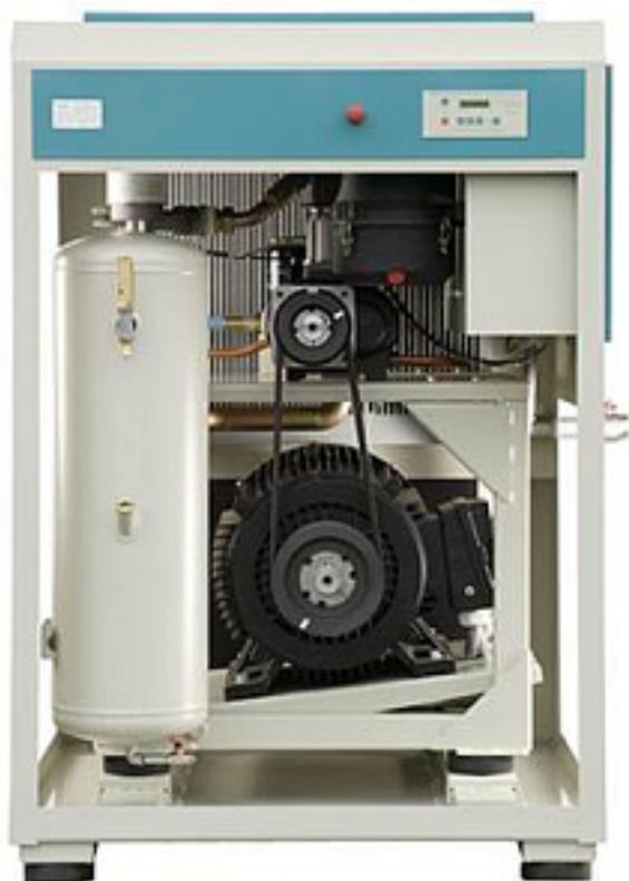
Наименование оборудования: [Электрокомпрессор винтовой с прямым приводом PC 132 D](#)
