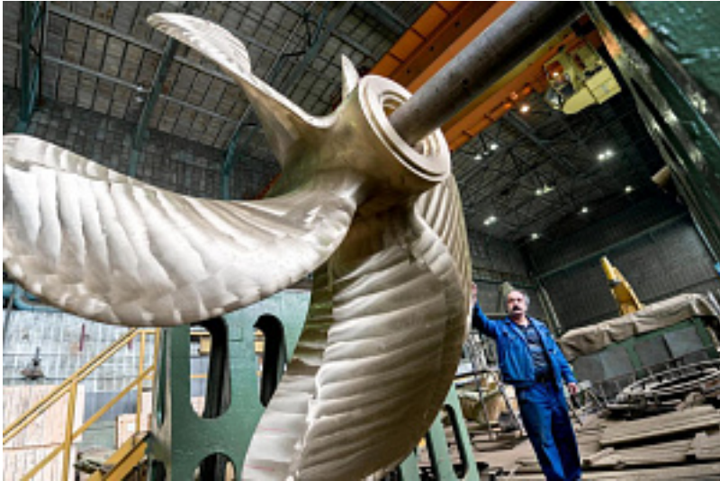
Наименование оборудования: Гребной винт из бронзы Производитель: АКЦИОНЕРНОЕ ОБЩЕСТВО "БАЛТИЙСКИЙ ЗАВОД"
