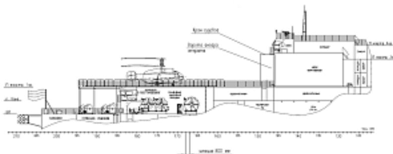
Наименование оборудования: [Устройство транспортировки вертолета](#)
