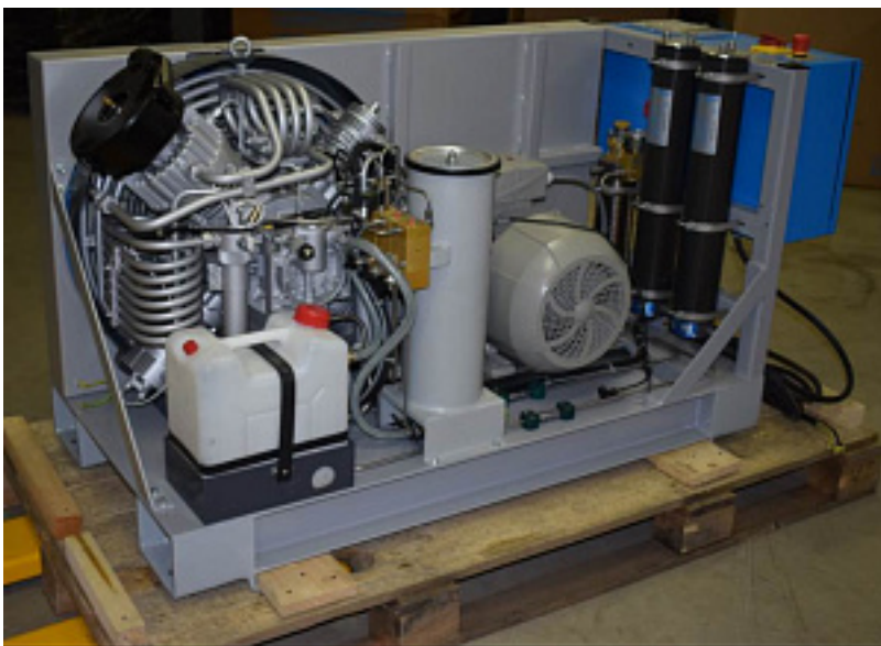
Наименование оборудования: Электрокомпрессор азотный дожимающий СК40А Производитель: ОБЩЕСТВО С ОГРАНИЧЕННОЙ ОТВЕТСТВЕННОСТЬЮ "СУДОВЫЕ СИСТЕМЫ"
