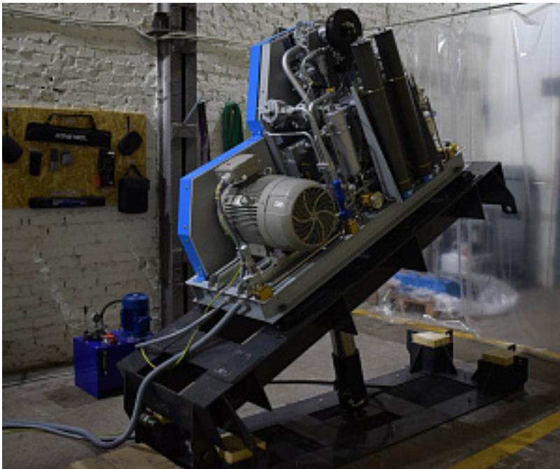
Наименование оборудования: Электрокомпрессор азотный дожимающий СК56А Производитель: ОБЩЕСТВО С ОГРАНИЧЕННОЙ ОТВЕТСТВЕННОСТЬЮ "СУДОВЫЕ СИСТЕМЫ"
