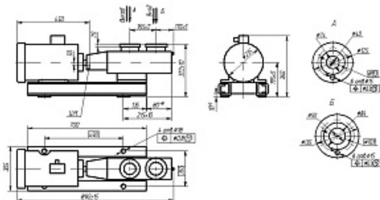
Наименование оборудования: [АГРЕГАТ ЭЛЕКТРОНАСОСНЫЙ А1 ЗВ 4/25-6.8/10Б](#)
