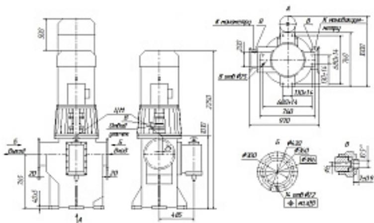
Наименование оборудования: [АГРЕГАТ ЭЛЕКТРОНАСОСНЫЙ А1 3Вx2 400/16-320/4Б](#)
