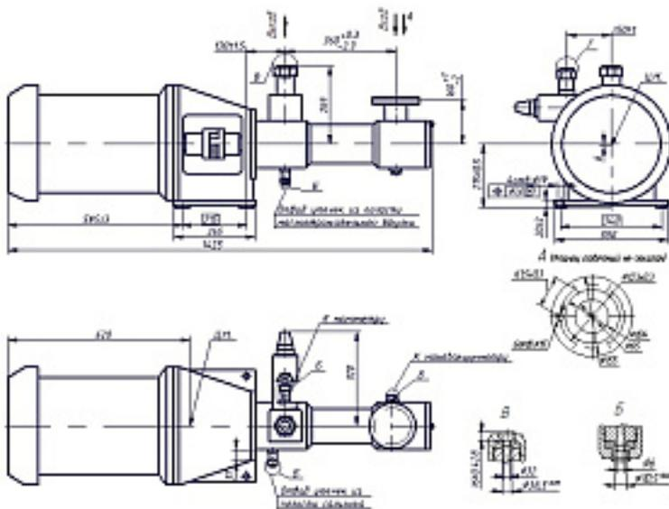
Наименование оборудования: [АГРЕГАТ ЭЛЕКТРОНАСОСНЫЙ А1 ЗВ 8/63-11/40Б-1](#)
