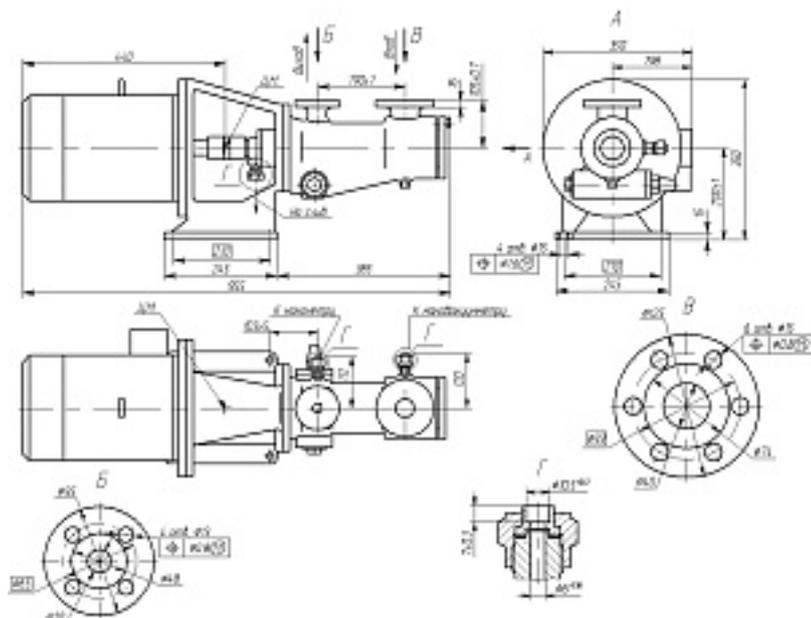
Наименование оборудования: [АГРЕГАТ ЭЛЕКТРОНАСОСНЫЙ А1 3В 1.6/40-3/25Б](#)
