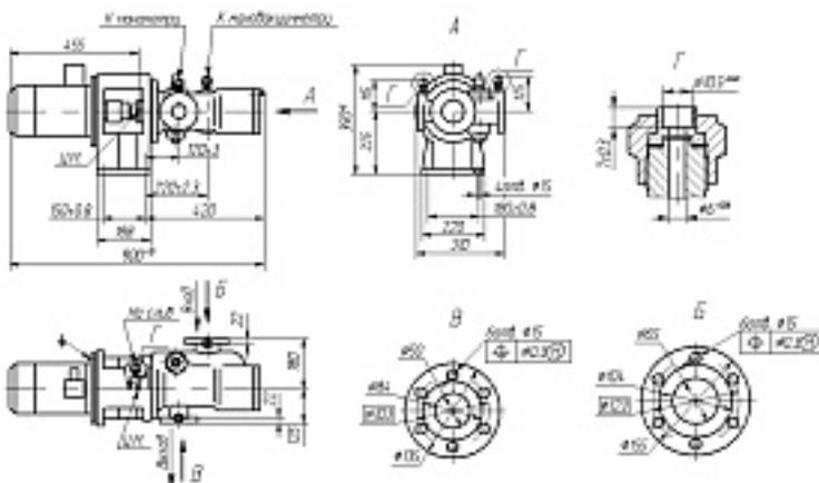
Наименование оборудования: [АГРЕГАТ ЭЛЕКТРОНАСОСНЫЙ А1 ЗВ 8/25-5/4Б](#)
