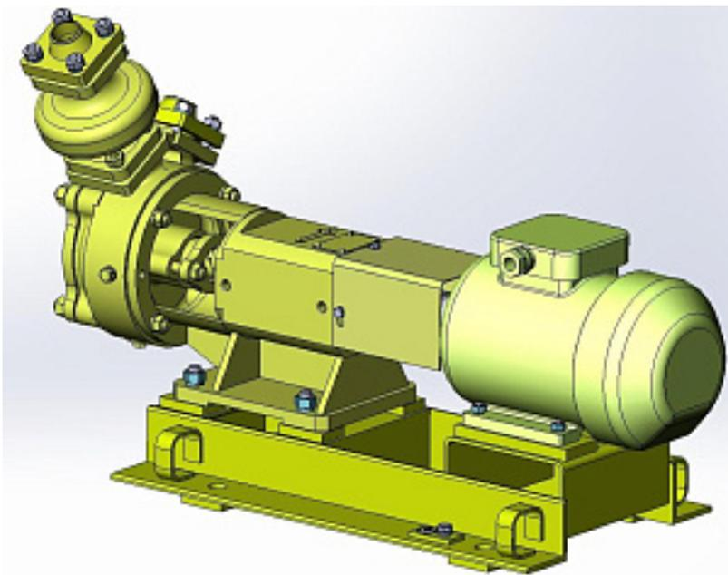
Наименование оборудования: [Агрегат электронасосный ВКС1/16 К](#)
