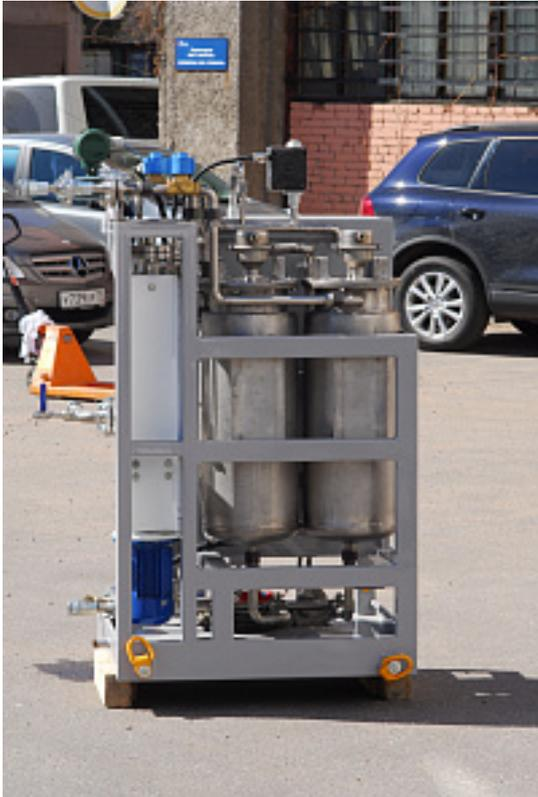
Наименование оборудования: [Сепаратор нефтесодержащих вод](#)
