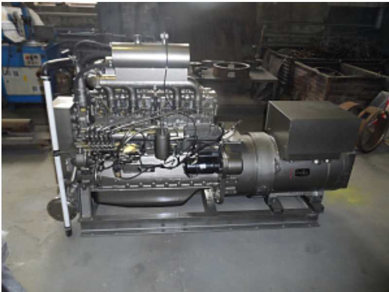
Наименование оборудования: ДГР2-60/1500.22-230(400) "Волга-60А2" Производитель: АКЦИОНЕРНОЕ ОБЩЕСТВО "ПФК ТВЕРЬДИЗЕЛЬАГРЕГАТ"
