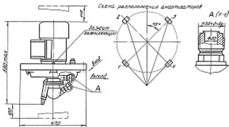
Наименование оборудования: [ЭЛЕКТРОНАСОС ОДНОВИНТОВОЙ 1В 1,6/5-2,5/2Б-2](#)
