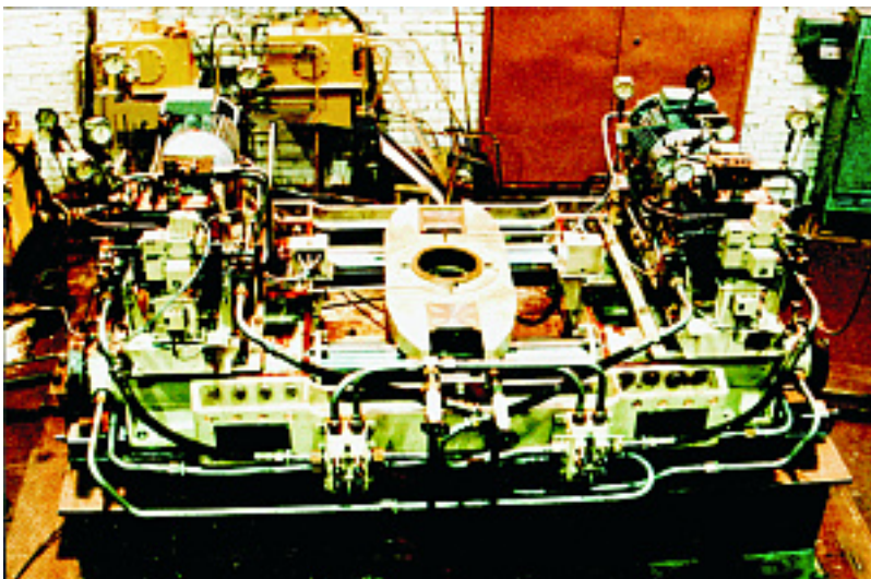
Наименование оборудования: Электрогидравлическая рулевая машина плунжерного типа Р15МЗ-2 Производитель: ЗАКРЫТОЕ АКЦИОНЕРНОЕ ОБЩЕСТВО "ЦЕНТРАЛЬНЫЙ НАУЧНО-ИССЛЕДОВАТЕЛЬСКИЙ ИНСТИТУТ СУДОВОГО МАШИНОСТРОЕНИЯ"
