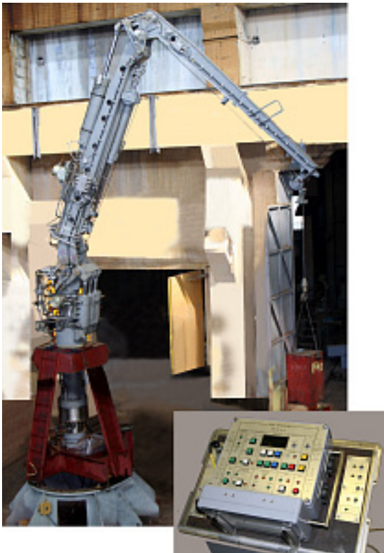
Наименование оборудования: Кран-манипулятор электрогидравлический КМ-1ЭГ-1, 6-9 Производитель: ЗАКРЫТОЕ АКЦИОНЕРНОЕ ОБЩЕСТВО "ЦЕНТРАЛЬНЫЙ НАУЧНО-ИССЛЕДОВАТЕЛЬСКИЙ ИНСТИТУТ СУДОВОГО МАШИНОСТРОЕНИЯ"
