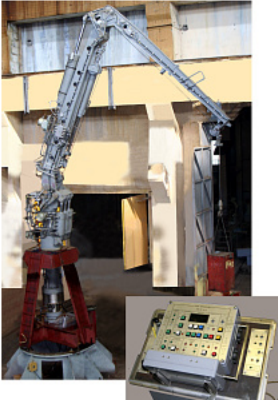
Наименование оборудования: Кран-манипулятор электрогидравлический КМ-1ЭГ-1 Производитель: ЗАКРЫТОЕ АКЦИОНЕРНОЕ ОБЩЕСТВО "ЦЕНТРАЛЬНЫЙ НАУЧНО-ИССЛЕДОВАТЕЛЬСКИЙ ИНСТИТУТ СУДОВОГО МАШИНОСТРОЕНИЯ"
