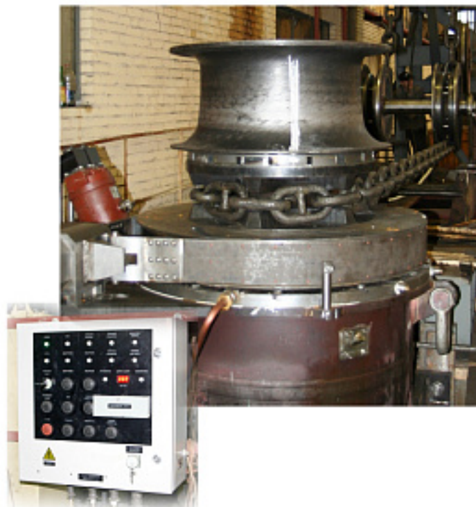
Наименование оборудования: Шпиль якорно-швартовный гидравлический ШГ-28 Производитель: ЗАКРЫТОЕ АКЦИОНЕРНОЕ ОБЩЕСТВО "ЦЕНТРАЛЬНЫЙ НАУЧНО-ИССЛЕДОВАТЕЛЬСКИЙ ИНСТИТУТ СУДОВОГО МАШИНОСТРОЕНИЯ"
