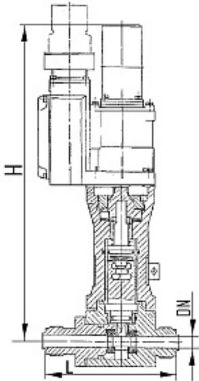
Наименование оборудования: [Кран запорный проходной шаровый штуцерный с электроприводом и ручным управлением, DN10мм, PN1,0МПа](#)
