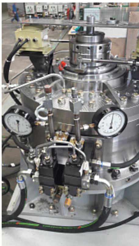
Наименование оборудования: [Роторная рулевая машина РРМ-300](#)
