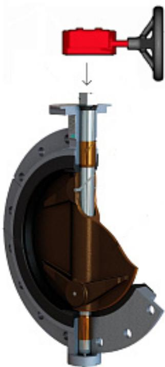
Наименование оборудования: [Монофланцевый затвор поворотный с ручным редуктором](#)
