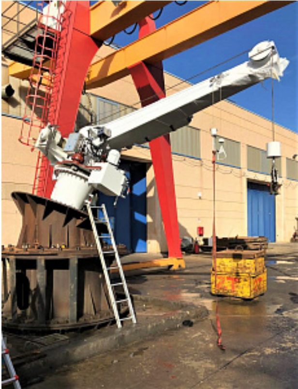
Наименование оборудования: Спуско-подъемное устройство плотов (СПУ) Производитель: ОБЩЕСТВО С ОГРАНИЧЕННОЙ ОТВЕТСТВЕННОСТЬЮ "СУДОСТРОЕНИЕ СУДОРЕМОНТ"
