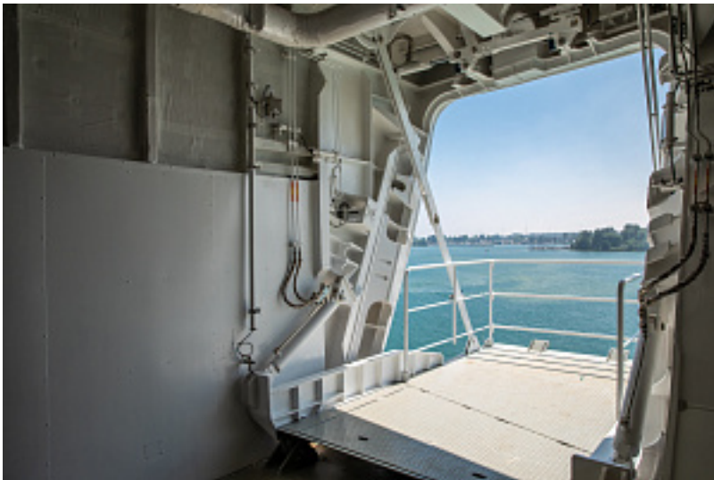
Наименование оборудования: Кормовое транцевое закрытие Производитель: ОБЩЕСТВО С ОГРАНИЧЕННОЙ ОТВЕТСТВЕННОСТЬЮ "СУДОСТРОЕНИЕ СУДОРЕМОНТ"
