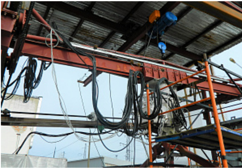
Наименование оборудования: МОСТОВОЙ КРАН Г/П З Т Производитель: ОБЩЕСТВО С ОГРАНИЧЕННОЙ ОТВЕТСТВЕННОСТЬЮ "СУДОСТРОЕНИЕ СУДОРЕМОНТ"
