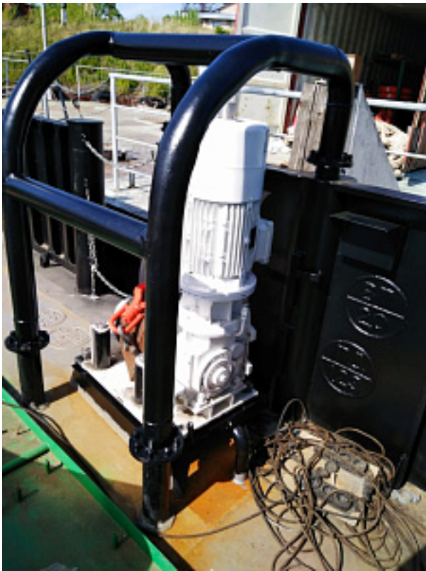
Наименование оборудования: Лебедка для подрыва якоря Производитель: ОБЩЕСТВО С ОГРАНИЧЕННОЙ ОТВЕТСТВЕННОСТЬЮ "СУДОСТРОЕНИЕ СУДОРЕМОНТ"
