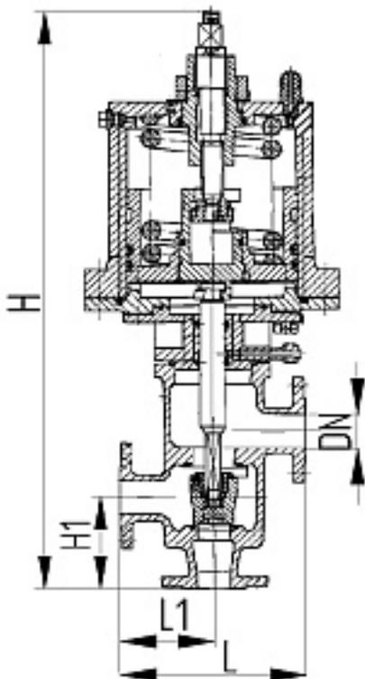
Наименование оборудования: [Клапан трехходовый с электропневмоприводом, DN40мм](#)
