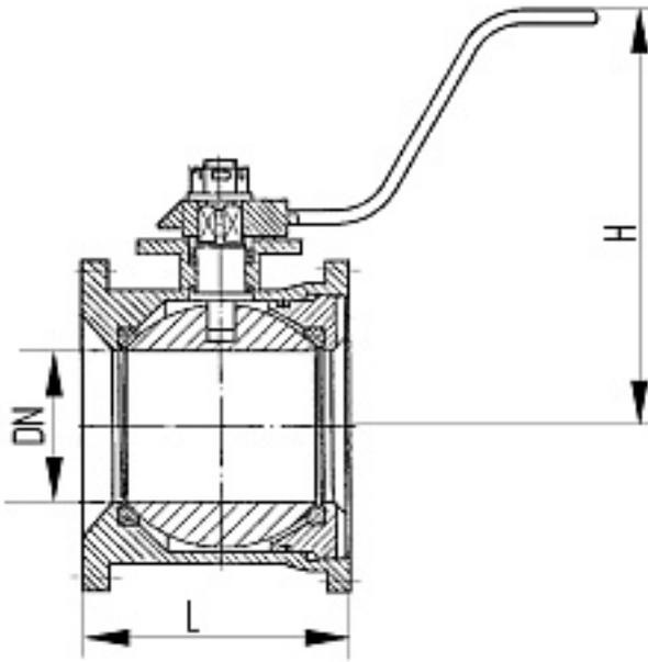
Наименование оборудования: [Клапан запорный проходной шаровый фланцевый с ручным управлением, DN80мм, PN1,0МПа](#)
