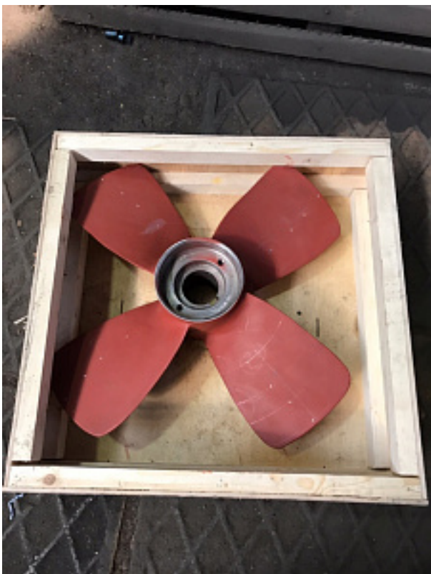
Наименование оборудования: Гребной винт 1361-968-3 Производитель: ОБЩЕСТВО С ОГРАНИЧЕННОЙ ОТВЕТСТВЕННОСТЬЮ "МЕТМАШ"
