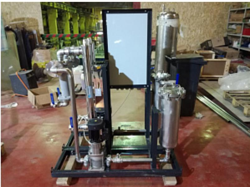
Наименование оборудования: [Установка очистки и опреснения воды с возможностью выдачи технической, питьевой и дистиллированной воды](#)
