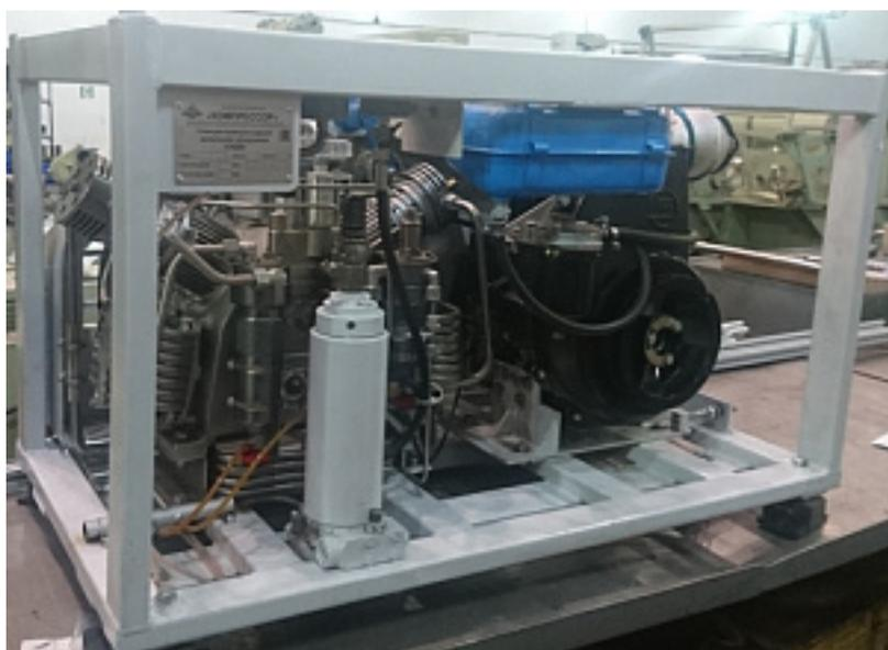
Наименование оборудования: [автоматизированный компрессор с приводом от дизеля СКДВ18/30](#)
