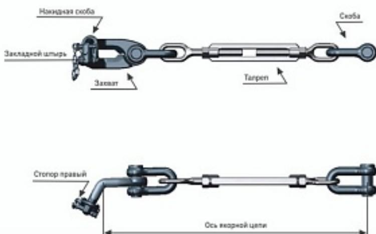
Наименование оборудования: [Стопор цепной тип 2 для цепей без контрфорсов для удержания якоря в клюзе](#)
