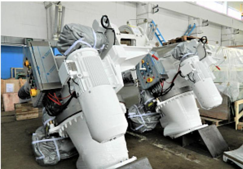
Наименование оборудования: [СПУСКОПОДЪЕМНОЕ УСТРОЙСТВО \(СПУ\) ДЛЯ ДЕЖУРНОЙ ШЛЮПКИ Г/П 2,4 Т](#)
