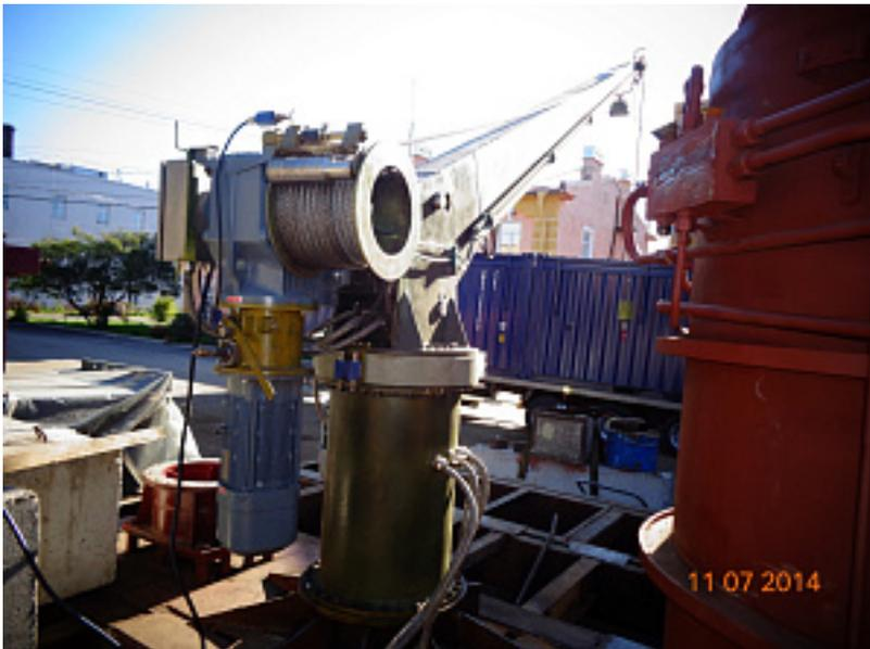
Наименование оборудования: [Спуско-подъемное устройство для дежурной шлюпки \(СПУ-1,7\) с автоматическим разобщающим устройством \(АРУ\), палубным фундаментом и крепежом](#)
